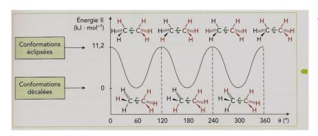
Variation de l'énergie d'une mole d'éthane en fonction de l'angle  $\theta$  d'un groupe méthyle par rapport à l'autre au cours de la rotation :
